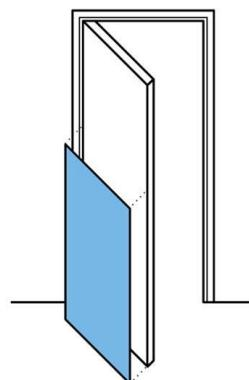
Fixation par encollage avec la colle acrylique. Convient à tout type de revêtements : Plâtre, Placo, Bois, Carrelage, Papier peint, PVC, Tôle métallique, Stratifié, Verre, Plexiglas. Possibilité de fixation par mastic-colle pour les petites surfaces.
