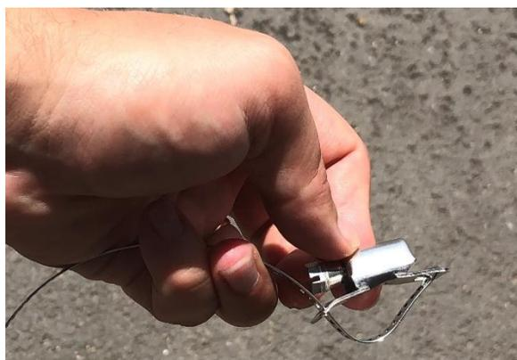
Repassez l'extrémité de la bande de l'autre côté de la cage à vis de façon à obtenir une boucle, comme la photo ci-dessus. Tirez la bande pour la faire ressortir de l'autre côté et la caler.
